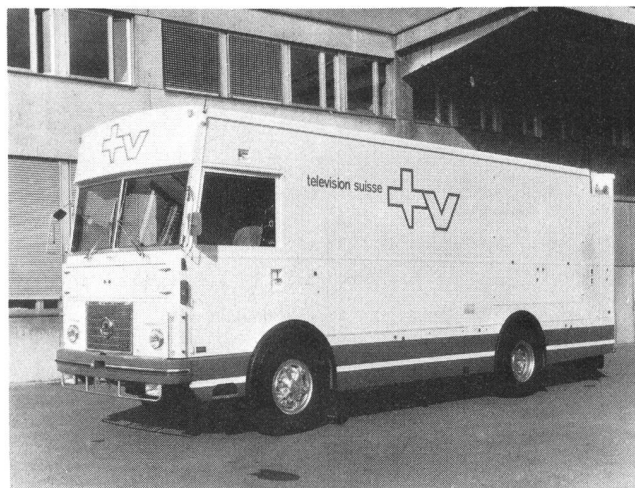
Fig. 1 Der neue Farbreportagewagen mit drei Kameras, bereit zur Fahrt – Nouveau car de reportage pour la télévision en couleur, équipé de trois caméras, prêt à prendre la route
