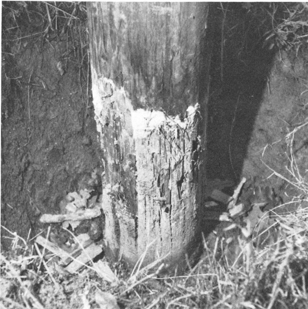
Fig. 7 Teilweise vom Pilz zerstörter Mast im Stangengarten
