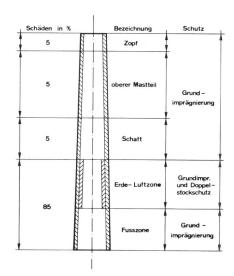
Fig. 10 Längsschnitt durch einen doppelt geschützten Mast (Doppelstockschutz)
