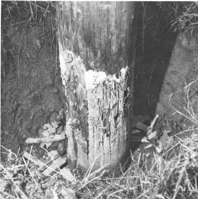
Fig. 7 Teilweise vom Pilz zerstörter Mast im Stangengarten
