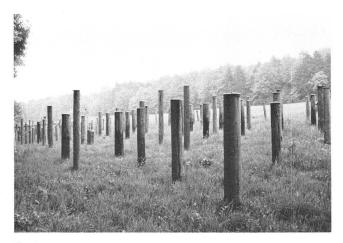
Fig. 6 Stangengarten für Dauerversuche bei Luzern
