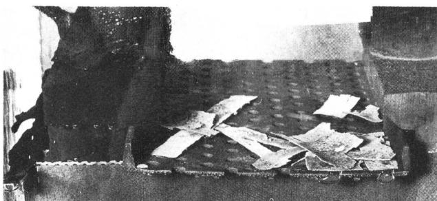
b Abgeblättertes Material derselben Zelle, das vom Polzapfen stammt – Matériel écaillé du même élément en provenance de la borne
