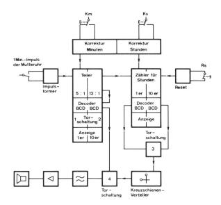
Fig. 9 Blockdiagramm der Weckeruhr
