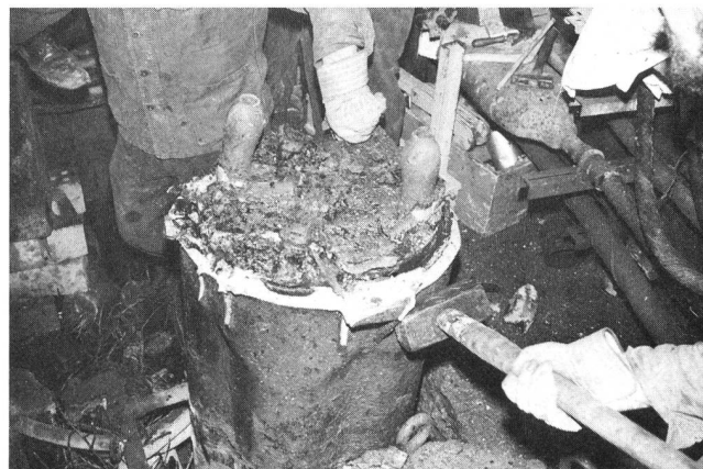
Fig. 6 Demolizione dei residui con la mazza
