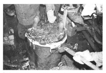
Fig. 6 Demolizione dei residui con la mazza
