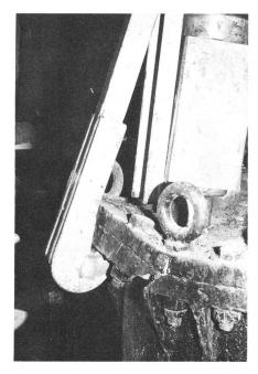
Fig. 5 Rottura del bordo del coperchio
