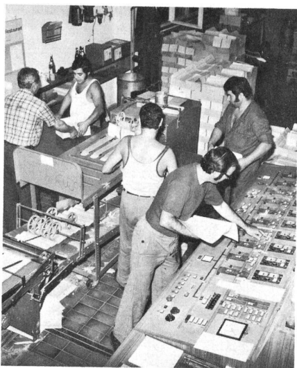
Fig. 10 Die Zuführung der zusammengetragenen Buchblocks erfolgt von der Zusammentragmaschine her in den «Rotorbinder», wo die Blocks am Buchrücken gefräst und anschliessend geleimt werden. Gleichzeitig werden die Umschläge auf eine Anpressplatte transportiert, gerillt und an den beleimten Buchrücken gepresst. Alsdann gelangt das fertige, unbeschnittene Buch auf dem Fliessband zur Schneideanlage
