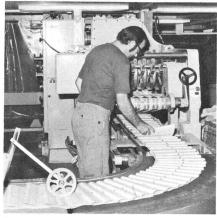
Fig. 9 Die Zusammentragmaschine mit 30 Bogenstatio-nen führt die Bogen direkt in den Klebebindeauto-maten. Die Stationen der Zusammentraganlage
