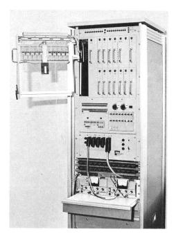
Fig. 1 Relaisprüfeinrichtung EPrG 1/20 und Speisegeräte in ein fahrbares Einheitsgestell eingebaut, mit Prüflingsplatte und Adapter eingesetzt
