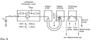
Lastkreis zur Prüfung von Relais zum Schalten von Sprechstromkreisen
