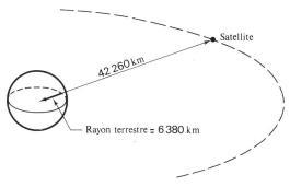
Fig. 1 Orbite d'un satellite géostationnaire
