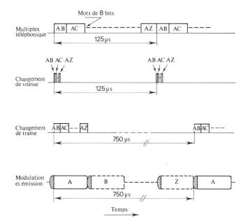
Fig. 5 Accès multiple à répartition dans le temps
