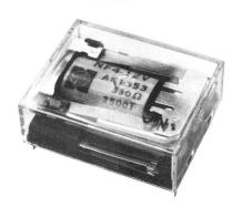
Flachrelais für Printeinsatz, niedrige Bauhöhe, hochohmige Wicklung, Doppellinienkontakte für 2 A. Auch hermetisch dicht mit Schutzgasfüllung zur Reduktion und Stabilisierung des Kontaktübergangswiderstandes 2 oder 4 Umschalter 2 A/60 W/100 VA Anspreche/Abfaltzeit 12/6 ms
