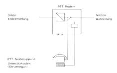
Fig. 1 Prinzip der Umschaltung
