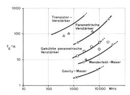
Fig. 10 Rauschtemperaturen verschiedener Verstärker
