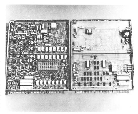
rig. 2 Leiterplatten eines Wahlumsetzers einer Haustelefonzentrale mit diskreten Bauelementen (links), rechts der funktions-, anschluss- und formatkompatible Baustein mit zwei MOS-LSI-Schaltungen als Kernstück
