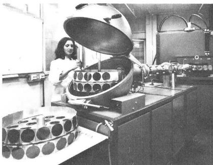
Fig. 5 Diese Ionenimplantationsanlage dient der Veränderung der elektrischen Eigenschaften oberflächennaher Zonen in Halbleitern. Dazu werden Ionen aus gasförmigen Verbindungen in einer Ionenquelle durch Plasmaentladung hergestellt, in einem elektrostatischen Feld auf hohe kinetische Energie gebracht, mit Hilfe eines Magneten sortiert und auf die Scheiben gerichtet. Die kinetische Energie bestimmt dabei die Eindringtiefe, die elektrische Ladung die eingebrachte Menge. Die Ionenimplantation wird vor allem bei der Herstellung von MOS-LSI-Schaltkreisen, von Tunnel-dioden und UHF-Transistoren benutzt.
