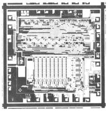
Fig. 3 Mikroaufnahmen der beiden MOS-LSI-Bausteine eines Wahlumsetzers, links der Baustein für die Parallelseriewandlung und Takterzeugung, rechts der MOS-Baustein, der unter anderem als Pufferspeicher dient
