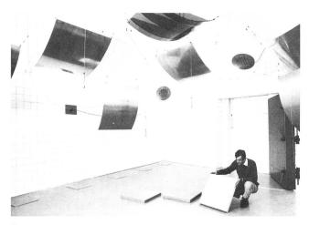
Fig. 7 Chambre réverbérante de la Division des Recherches et du Développement de l'Entreprise des PTT suisses, permettant la mesure du coefficient d'absorption des matériaux accoustiques selon la recommandation R 354 de l'ISO
