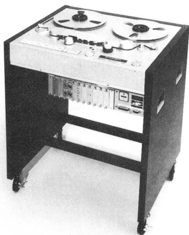
Fig. 5 Magnétophone Studer A 80, modèle le plus récent, entièrement transistorisé
