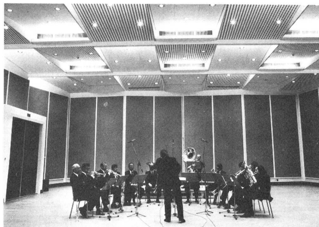
Fig. 8 Nouveau studio de 1600 m 3 construit à Lausanne en 1975, équipé de panneaux mobiles revêtant les murs
