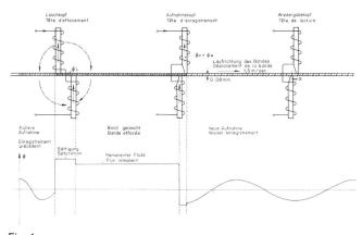
Fig. 1 Enregistreur Lorenz à bande d'acier des années 1940–1947. La partie inférieure schématise le principe de l'enregistrement
