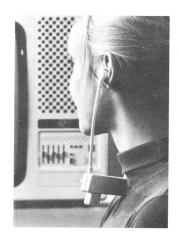
Fig. 12 Infrarot-Ohrhörer mit in den Bügel eingebautem Empfänger und Stromversorgung (unten links) (Foto Metz)
