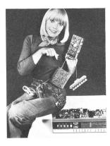
Fig. 8 Modulartige Bausteine gelangen vereinzelt auch für den Bau von Radiogeräten und Tunern zur Anwendung. Mit hier gezeigten Elementen werden von Loewe-Opta verschiedene Geräte bestückt
