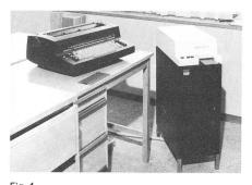
Fig. 1 Modèle IBM MC 72, qui utilise des cartes magnétiques comme support d'information
