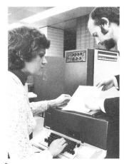
Fig. 3 Fernschreibnebenstellanlage, die den Aufbau eines Hausnetzes mit bis zu 200 Teilnehmer gestattet (Siemens)
