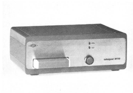
Fig. 2 Telefonwählgerät Telesignal zur automatischen Wahl einer Pikettstelle und Übermittlung einer gesprochenen Meldung (Gfeller)
