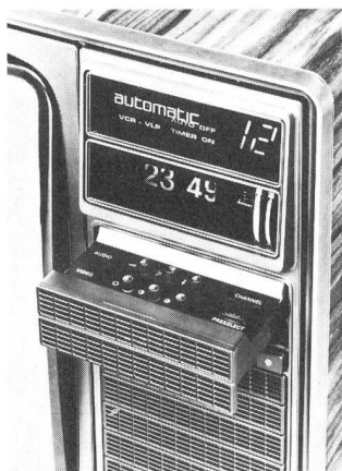
Fig. 5 Programm- und Zeitanzeige, letztere gekoppelt mit einer Schaltuhr für das Ein- und Ausschalten des Fernsehgerätes, neben dem Bildschirm. Unterhalb der Digitaluhr das Schubfach mit den Audio- und Videoeinstellungen sowie dem Programmschalter für den Handbetrieb des Gerätes, wenn nicht die Fernbedienung benutzt wird (Foto Philips)
