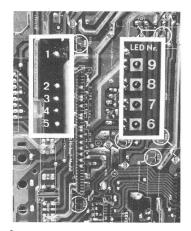
Fig. 2 Steckmoduln mit eingebautem Diagnosesystem mit 9 lichtemittierenden Dioden (LED): 5 auf dem Netzteil, 4 auf dem Kippteil. Eine nicht mehr leuchtende LED zeigt einen Defekt im betreffenden Modul an (Foto Siemens)
