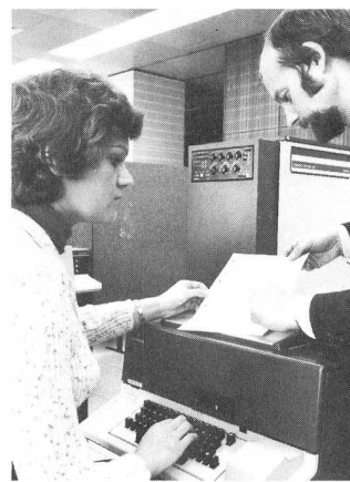
Fig. 3 Fernschreibnebenstellenanlage, die den Aufbau eines Hausnetzes mit bis zu 200 Teilnehmer gestattet (Siemens)
