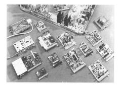
Fig. 1 Steckbare Moduln eines Farbfernsehgerätes. In der vordern Reihe, als zweiter von rechts, der Quarzuhr-Baustein, der die Anzeige von Zeit, Programmziffer und Kanalskala auf dem Bildschirm bewirkt (Foto Grundig)
