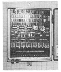
Fig. 1 Vollelektronischer Leitungsreduktor für die Schaltung von 7 Teilnehmeranschlüssen über 2 Verbindungsleitungen (Autophon)
