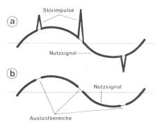
Fig. 13 Automatische UKW-Störimpulsaustastung (ASU). Niederfrequenzsignal mit Störimpulsen (a) und nach Austastung der Störimpulse (b)
