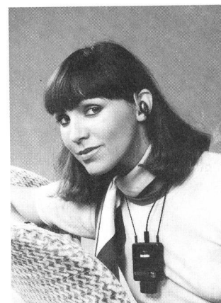
Fig. 11 Infrarot-Hörset mit umhängbarer Empfangselektronik und Kleinhörer (Foto Grundig)
