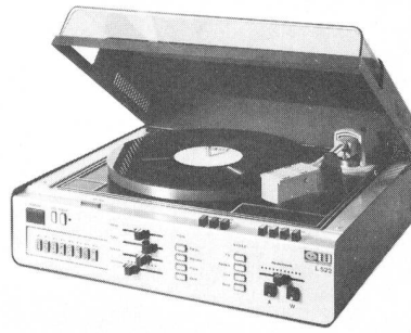
Fig. 17 MDR-Plattenspieler für die magnetische Aufzeichnung und Wiedergabe von farbigen Fernsehbildern (mit eingebautem Tuner), für die magnetische Aufzeichnung und Wiedergabe von Sprache und Musik, die Wiedergabe handelsüblicher Schallplatten und den Empfang von UKW-Radiosendungen (Foto MDR-Rabe)
