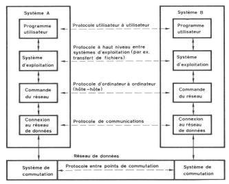
Fig. 8 Schématisation des différents protocoles
