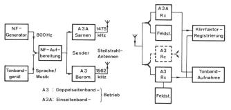
Fig. 1 Blockschaltbild der Versuchsanordnung – Schéma de principe de l'agencement d'essai
