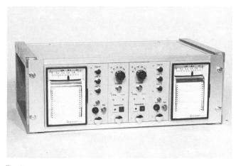
Fig. 2 Klirrfaktormessgerät für zwei Kanäle – Mesureur du facteur de distorsion pour deux canaux
