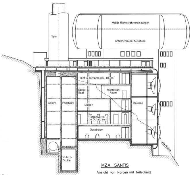
Fig. 2 Ansicht des Nordtrakts mit seiner Stockwerkaufteilung
