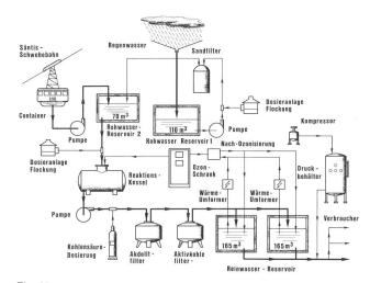
Fig. 15 Die Wasserversorgung für PTT-Anlage, Bahn- und Hotelbetrieb
