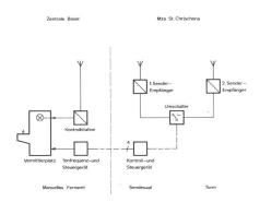
Fig. 2 Blockschema der gesamten Rheinfunkanlage
