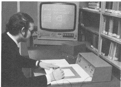
Fig. 1 Die «elektronische Wandtafel» mit Schreibgerät und Fernsehempfänger
