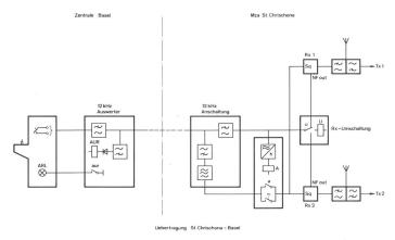
Fig. 5 Blockschema Übertragungsweg Schiff-Zentrale
