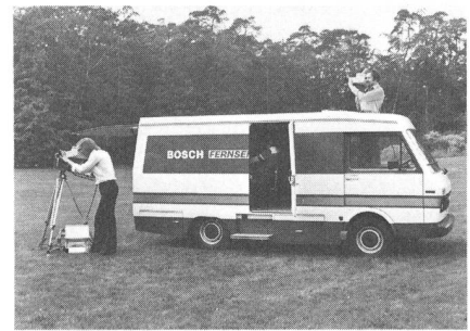
Fig. 6 Klein-Reportagewagen mit portabler Farbfernsehkamera [Bosch-Fernseh]
