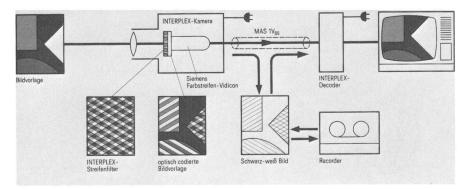
Fig. 5 Prinzip des Interplex-Einröhren-Verfahrens
