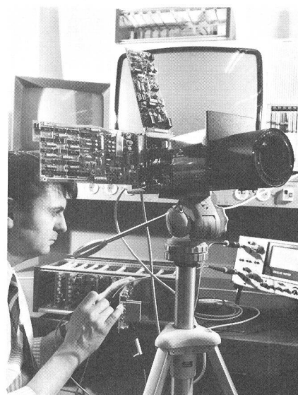
Fig. 3 Einröhren-Farbfernsehkamera, bei der ein neuartiges optisches Farbstreifenfilter (Interplex) verwendet wird [Siemens]
