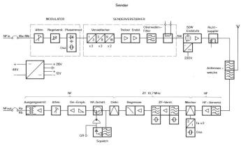
Fig. 6 Blockschema des Senders und Empfängers
