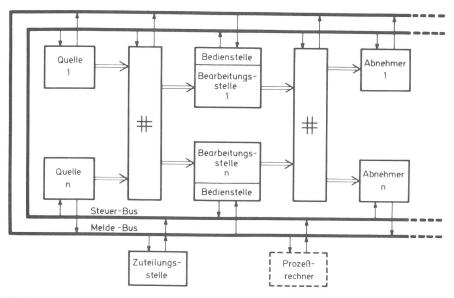
Fig. 1 Schematischer Aufbau eines Fernsehanlagenkomplexes mit AFRA-Bus-System
