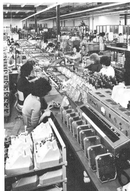
Fig. 3 Fertigungsstrasse für Telefonapparate im Werk Hombrechtikon
