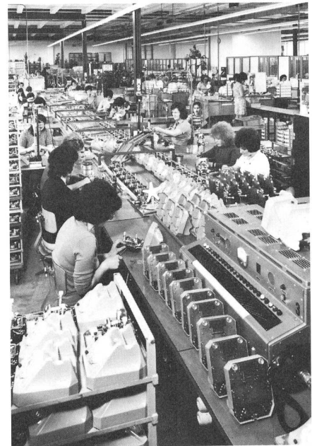
Fig. 3 Fertigungsstrasse für Telefonapparate im Werk Hombrechtikon
