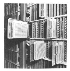
Fig. 1 Minikreuzschalter-Leiterplatten
