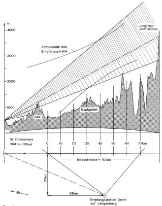
Fig. 2 Messung von Streureflexionen mit passivem Radar
