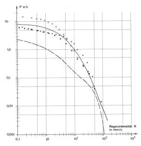
Fig. 13 Wahrscheinlichkeit in Prozent der Zeit, dass eine gewisse Regenintensität überschritten wird
