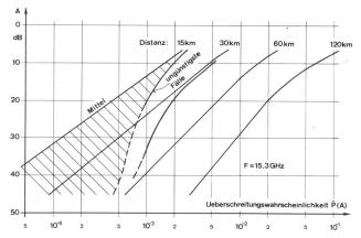
Fig. 14 Regendämpfungen A auf Richtfunkstrecken
