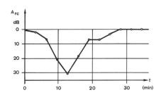
Fig. 7 Vergleich zwischen gemessener Dämpfung  $A_{\text{rm}}$  und berechneter Dämpfung  $A_{\text{rc}}$
