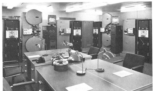
Fig. 13 Télécinéma à système multiplex – Multiplex-Filmabtaster
