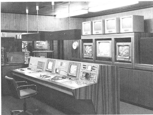
Fig. 12 Poste de travail pour le contrôle technique de l'image d'une régie de continuité – Arbeitsplatz für die technische Bildkontrolle in einer Ablaufregie
