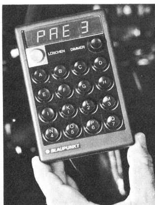
Fig. 2 Modell eines Zieleingabegerätes für das ALI-System. Die Wahl des 4stelligen Ziels erfolgt über die insgesamt 16 Tasten mit den Zielbuchstaben A bis Q. Sieben Tasten dienen nach Umschaltung gleichzeitig als Zifferntasten für die letzte Stelle der Zieladresse - Modelle d'un appareil d'introduction des données de but du système ALI. Le choix du but s'opère par pression sur 4 touches parmi 16 (lettres A...Q). 7 touches sont utilisées, après la commutation, pour l'émission des chiffres de la dernière position de l'adresse
