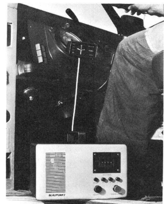
Fig. 6 Tragbare Ausführung des ALI-Fahrzeuggerätes, bestehend aus Empfänger, Sender und Anzeigefläche. Die Ferritantenne wird im Kotflügel montiert – Exécution portable de l'appareil pour véhicule, composé d'un récepteur, d'un émetteur et d'un tableau indicateur. L'antenne de ferrite est montée sous l'aile du pare-boue
