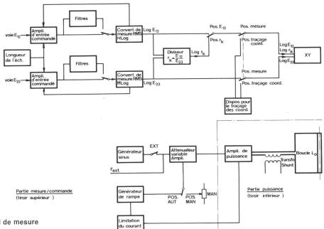
Fig. 11 Schéma bloc de l'appareil de mesure du facteur de réduction
