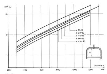
Fig. 5 Mesure de la boucle. Inductivité en fonction de la distance. Echantillons: tubes en cuivre
