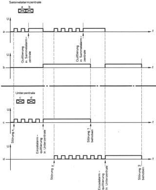
Fig. 2 Beispiel eines Störsignalablaufs
