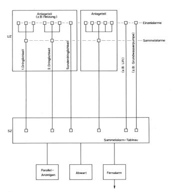
Fig. 1 Prinzip der Störsignalverarbeitung
