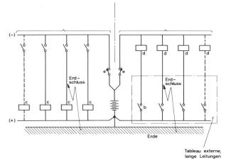
Fig. 3 Prinzip der Alarmerfassung
