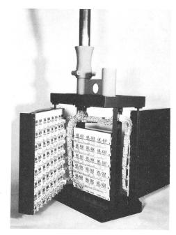
Fig. 6 Caisson en acier ouvert, montrant la disposition intérieure des panneaux portant les bobines
