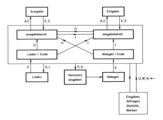
Fig. 5 Vereinfachtes Zustandsdiagramm und Verzeichnis der Befehle
