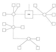
Fig. 2 Mehrpunkt-Verbindungsnetz
