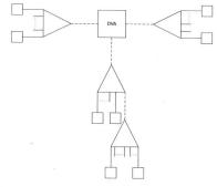
Fig. 3 Datennetz mit Konzentratoren
