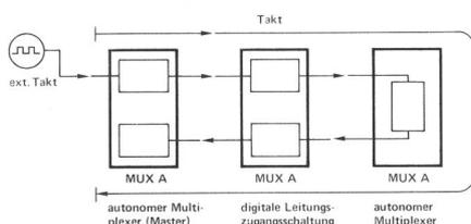
Fig. 7 Taktschleifung – Circuit de boucle des signaux d'horloge
