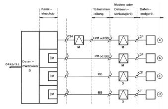
Fig. 3 Verschiedene Möglichkeiten von 2,4-kbit/s-Teilnehmeranschlüssen
