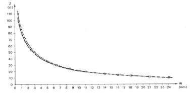
Fig. 17 Wellenwiderstand Zo = f(w) (geätzte Streifen)
