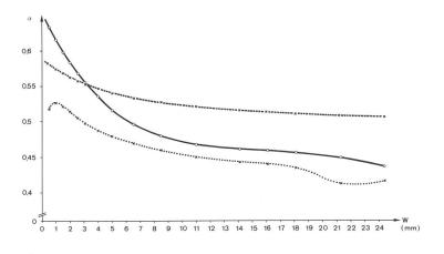
Fig. 14 Propagationskonstante  $\alpha = f(w)$  (geklebte Streifen)
