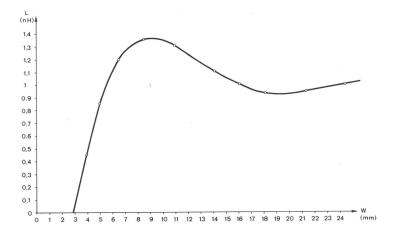
Fig. 21 Anschlussinduktivität L = f(w) (geklebte Streifen)
