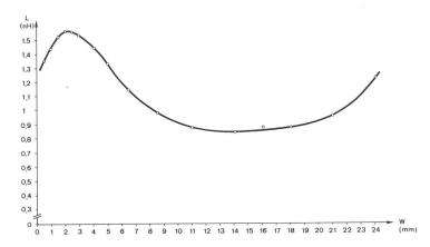
Fig. 22 Anschlussinduktivität L = f(w) (geätzte Streifen)
