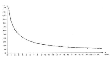
Fig. 15 Wellenwiderstand Zo = f(w) (geklebte Streifen)
