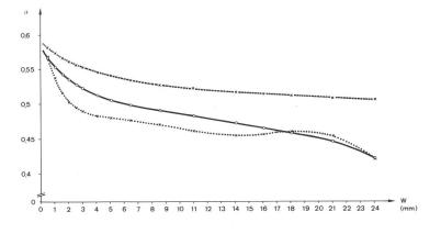
Fig. 16 Propagationskonstante  $\alpha = f(w)$  (geätzte Streifen)
