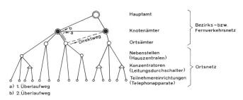
Fig. 2 Beispiel einer Telefonnetzstruktur
