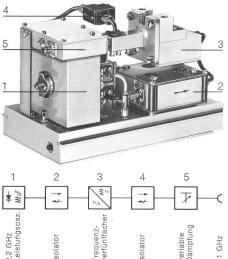
Aufbau des 11-GHz-Oszillators
