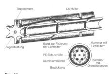
Fig. 11 Tragelement und Querschnitt eines Lichtleiterkabels mit Schutzmantel
