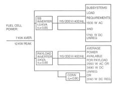
Fig. 6 Das hybride Stromversorgungsprinzip eines Spacelab
