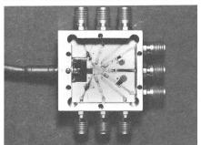
Fig. 9 Glasfaser-Multiplexer für vier Kanäle von 250 Mbit/s
