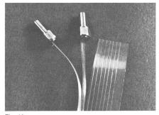
Fig. 10 Glasfasern als Bandkabel, teilweise mit Steckverbindung
