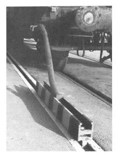
Fig. 1 Schlepper mit Verbindungsstange der Eisenbahnwagen-Schiebeanlage
