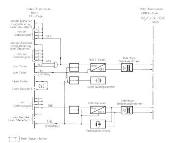
Fig. 9 Die HDB3-Codier-/Decodiereinrichtung
