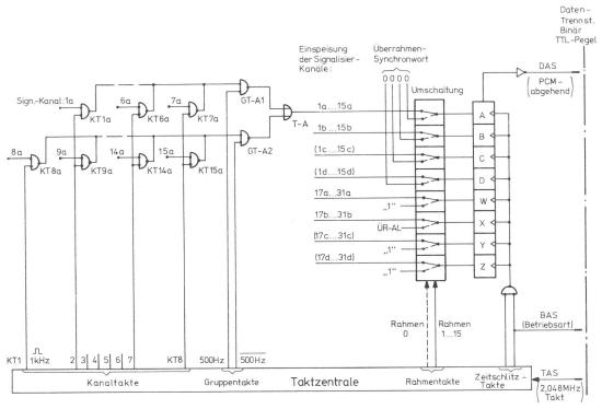
Fig. 5 Sendeseite der Signalisierzeichenübertragung
