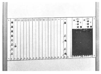
Fig. 14 Ausbau des Systembaugruppenträgers bei Verwendung in Vermittlungsnetzen
