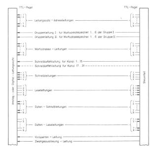
Fig. 12 Schnittstellenleitungen zwischen Steuerteil und Leitungssatz
