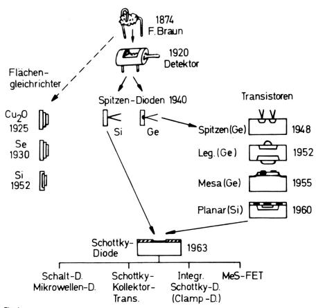
Fig. 1 Mit der Entdeckung des Gleichrichtereffektes von Kristallen durch Ferdinand Braun kam 1874 eine Entwicklung in Gang, die über den Kristalldetektor und eine Reihe von Gleichrichterbauformen zur Transistortechnologie führte. Die besonders für
