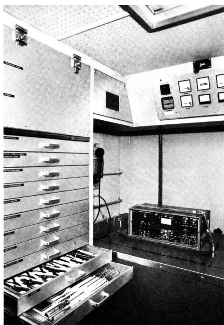
Fig. 7 Links Ersatzteil- und Werkzeugschrank, rechts betriebsbereiter Richtstrahlkontrollteil
