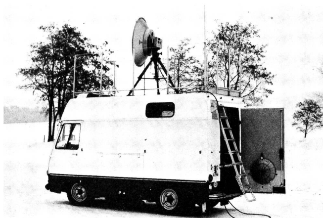
Fig. 1 Fahrzeug in Betriebsstellung mit Richtstrahlspiegel und Dachge-länder. Chassis Peugeot J7, Gesamtgewicht 3,5 t
