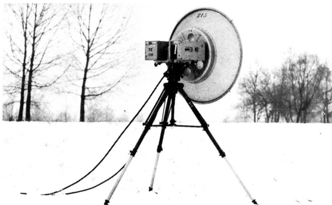
Fig. 10 Mit einem Diplexer lassen sich zwei Richtstrahlverbindungen mit einer Antenne betreiben
