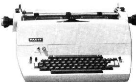
*Input/Output-Typewriter.* Schreibgeschwindigkeit bis zu 12 Zeichen/Sekunde. Paritätskontrolle unmittelbar an der Quelle. Echo-Check. Völlige
