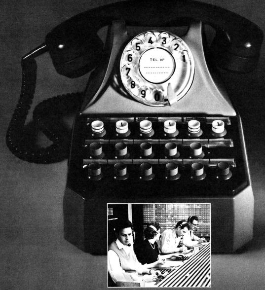
Durch einfachen Tastendruck: Ruf eines internen Teilnehmers Anschaltung einer Amtsleitung Rückfrage intern mit besonderer Signalisation der gehaltenen Leitung
