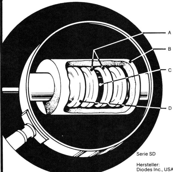
A Hartgelötete Verbindung Kristall-Anschlussdrähte garantiert verbesserte mechanische Festigkeit.
