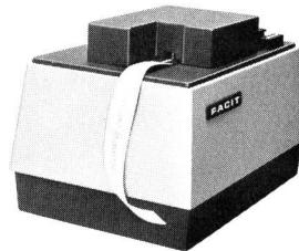
Neuer alphanumerischer Streifendrucker. Bis zu 15 Zeichen/Sekunde. Druck auf chemisch präparierte, druckempfindliche Papierstreifen. Lieferbar in zwei Versionen mit Steuer-Elektronik und eingebautem Zeichen-
