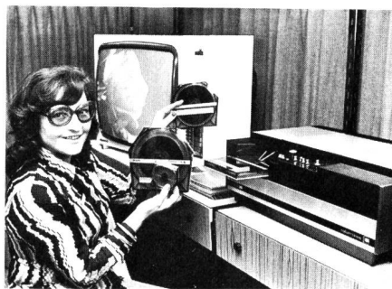
Fig. 1 Film-Apparatur für die elektronische Abtastung von kassettierten Super-8-Filmen (CCS-Verfahren) zur Wiedergabe über den Bildschirm
