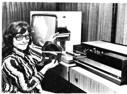
Fig. 1 Heim-Apparatur für die elektronische Abtastung von kassettierten Super-8-Filmen (CCS-Verfahren) zur Wiedergabe über den Bildschirm
