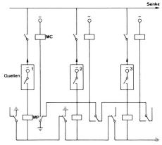
Fig. 1 Beispiel für die Anwendung einer Relaiskette
