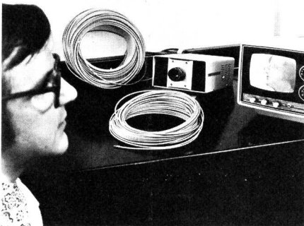
Fig. 1 Misure di attenuazione su lunghi tratti di guide d'onda ottiche. La Corning è riuscita a produrre guide d'onda in vetro lunghe fino a tre chilometri con attenuazione media di 4 dB/km
