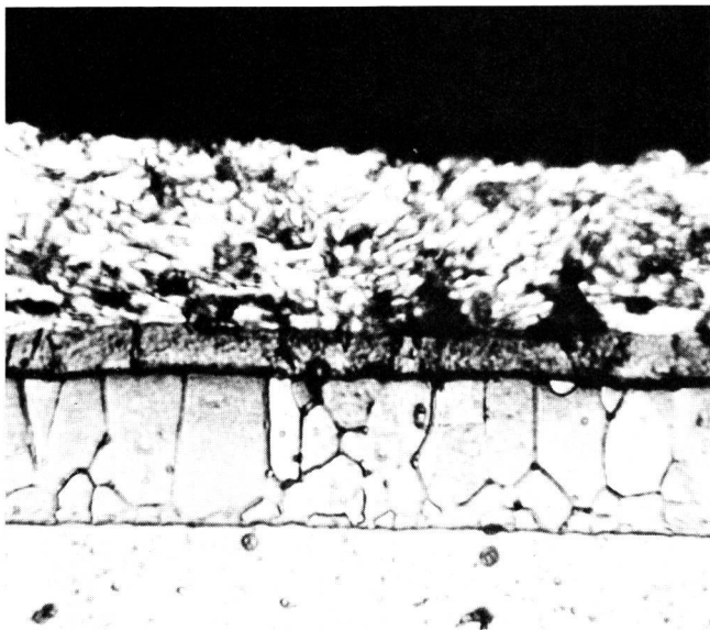
Fig. 9 Querschnitt durch eine bei extrem tiefer Badtemperatur (430° C) während 1 min entstandene Verzinkung. Es bildet sich eine etwas dickere Reinzinkschicht. Die Legierungsschichten weisen dagegen ähnliche Stärken auf wie bei den in 470° C heisser Schmelze verzinkten Proben. Es ist keine «anliegende Schicht» sichtbar – Coupe de la couche protectrice obtenue par immersion d'une minute dans un bain à température extrêmement basse (430° C). Une couche de zinc pur un peu plus épaisse s'est formée. Les couches d'alliages, en revanche, ont pratiquement la même épaisseur que pour les échantillons zingués dans un bain à 470° C. Aucune «couche en contact direct» n'est visible. Vergrösserung 900fach – Agrandissement 900 fois
