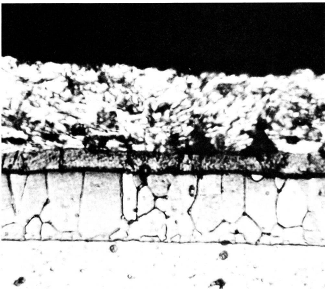
Fig. 9 Querschnitt durch eine bei extrem tiefer Badtemperatur (430° C) während 1 min entstandene Verzinkung. Es bildet sich eine etwas dickere Reinzinkschicht. Die Legierungsschichten weisen dagegen ähnliche Stärken auf wie bei den in 470° C heisser Schmelze verzinkten Proben. Es ist keine «anliegende Schicht» sichtbar – Coupe de la couche protectrice obtenue par immersion d'une min dans un bain à température extrêmement basse (430° C). Une couche de zinc pur un peu plus épaisse s'est formée. Les couches d'alliages, en revanche, ont pratiquement la même épaisseur que pour les échantillons zingués dans un bain à 470° C. Aucune «couche en contact direct» n'est visible. Vergrösserung 900fach – Agrandissement 900 fois
