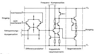
Fig. 13 Schaltungsaufbau eines monolithischen Operationsverstärkers
