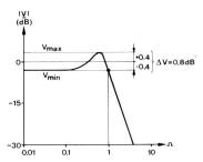
Fig. 22 Frequenzgang der Verstärkung gemäss Beispiel
