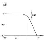
Fig. 17 Frequenzgang der Verstärkung von Tiefpässen nach Bessel
