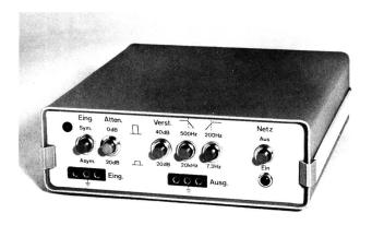
Fig. 28 Frontansicht des Rumpelmessgerätes
