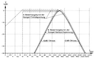
Fig. 6 Normierte Kurve nach DIN 45539
