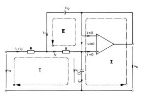
Fig. 21 Analyse der Schaltung
