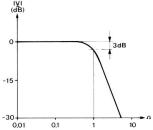
Fig. 15 Frequenzgang der Verstärkung von Tiefpässen nach Butterworth
