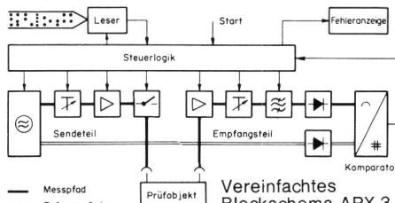
Diese wird in einem Komparator mit einer Referenzgleichspannung von ebenfalls 4 V verglichen. Um die Genauigkeit und Stabilität der Komparator-Entscheidung zu erhöhen, wird die Referenzspannung durch Gleichrichtung aus dem Sendeoszillator-Signal abgeleitet. Je nachdem, ob die empfangene Signalspannung grösser oder kleiner als der programmierte Grenzwert ist, gibt der Komparator einen entsprechenden Binärenentscheid an die Steuerlogik des Gerätes weiter («gut-schlecht»-Prinzip).
