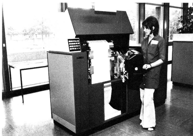
Fig. 4 Schnelldrucker Modell IBM 3211, Leistungsfähigkeit 2000 Zeilen/Minute – Imprimante rapide modèle IBM 3211, capacité 2000 lignes/minute
