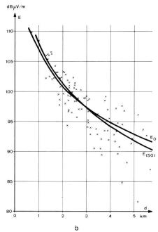
Fig. 5 Höhenfunktionsmittelwerte  $\overline{\textbf{E}}$  in Abhängigkeit der Distanz (K45,  $P_{\text{ed}}=1~\text{kW})$
