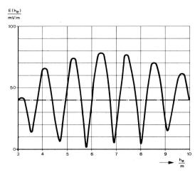
Fig. 3 H-Funktion mit zwei überlagerten Reflexionswellen (Simmental)
