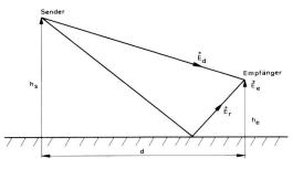
Fig. 1 Bodenreflexion auf der Verbindungslinie zwischen Sender und Empfänger
