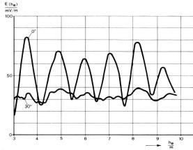
Fig. 10 Ausgeebnete H-Funktion mit 30° nach oben geneigter Empfangsantenne
