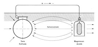
Schutzverfahren mit Opferanode
