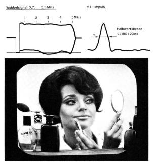
Wobbelsignal, 2T-Impuls und Foto des Dias «Philips-Girl Nr. 14» für a) Kleinkoaxialtube im ursprünglichen Zustand  $f_{BT} = 62,25 \text{ MHz}$
