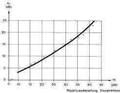
Fig. 9 Zusammenhang zwischen Einzelreflexion und Gesamtrückfluss (mit Z = 75  $\Omega$ ) für eine mittlere Verstärkerfeldlänge (ca. 500 m) A<sub>r</sub> (dB) = Rückflussdämpfung bei der künstlichen Resonanz a. (dB) = Rückflussdämpfung Einzelreflexion
