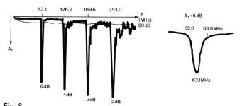
Rückflussdämpfung im VHF-Bereich und Ausschnitt bei 63 MHz aus dem Frequenzgang der Rückflussdämpfung
