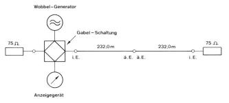
Fig. 5 Messung der Rückflussdämpfung i. E. inneres Ende des Haspels ä.E. äusseres Ende des Haspels
