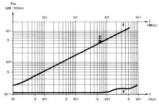
Fig. 1 Betriebsdämpfung  $A_m=f$  (f) der Kleinkoaxialtube 1,18/4,43 mm, Ballontyp Länge 232,0 m Kabeltemperatur  $+19^\circ$  C Aussenleiter isoliert
