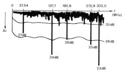
Fig. 3 Rückflussdämpfung der Kleinkoaxialtube Zustand vor dem Einbau der künstlichen Reflexionsstellen
