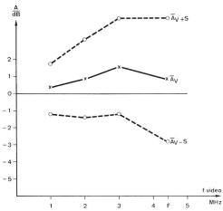
**6b** Dämpfungsverzerrung innerhalb des Fernsehkanals Verteilanlage,  $A_{\mathbf{v}}$  Verzerrung der Verteilanlage
