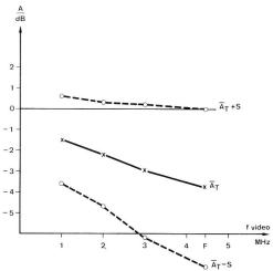
Fig. ba Dämpfungsverzerrungen innerhalb des Fernsehkanales Verstärkerausgang, A<sub>T</sub> Verzerrung beim Teilnehmer
