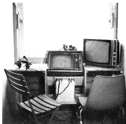
Fig. 10 Reporterkabine Zielhaus Abfahrt mit Sende- und Kontrolleinrichtung. Kontrollempfänger und Datenempfänger
